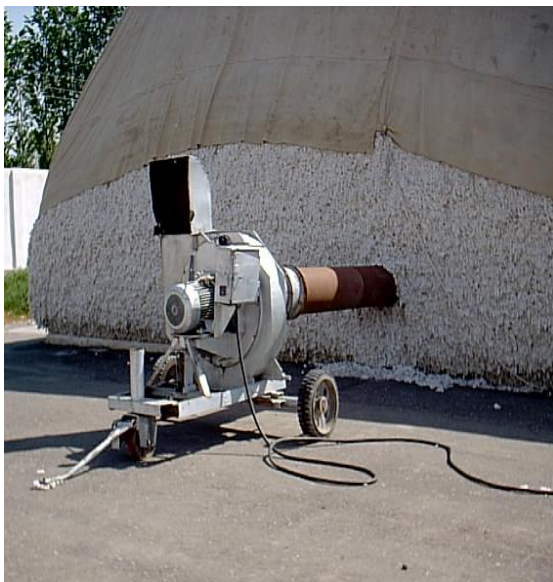
9-rasm. UVP rusumli kochma ventilyatorning g'aramga ornatilishi va qurilmaning tuzilishi. 1-markazdan qochuvchi ventilyator; 2-havoni chiqarish quvuri; 3-koziyok; 4-drossel qopqog'i; 5-havo tortish tog'ri quvuri; 6-g'ildiraklar (bitta aylanuvchi va ikkita tayanch); 7-elektir dvigatel; 8-elektir tosiq.
