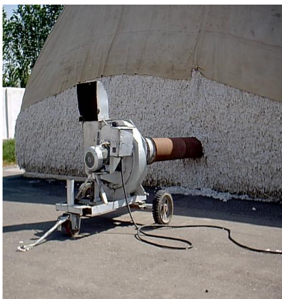
9-rasm. UVP rusumli kochma ventilyatorning g'aramga o'rnatilishi va qurilmaning tuzilishi. 1-markazdan qochuvchi ventilyator; 2-havoni chiqarish quvuri; 3-koziyok; 4-drossel qopqog'i; 5-havo tortish tog'ri quvuri; 6-g'ildiraklar (bitta aylanuvchi va ikkita tayanch); 7-elektr dvigatel; 8-elektr tosiq.
