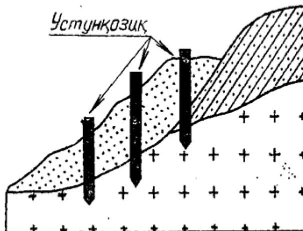
14-расм. Сурилаётган қияликлар-ни сваялар (қозиклар) ёрдамида мустаҳкамлаш.
