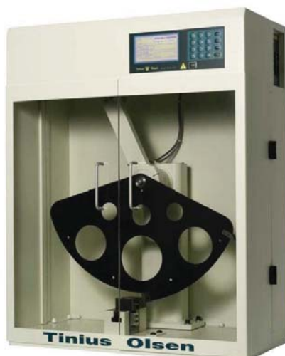
Рис. 18.5. Маятниковый копр для испытаний пластмасс на ударную вязкость по Шарпи или Изоду
