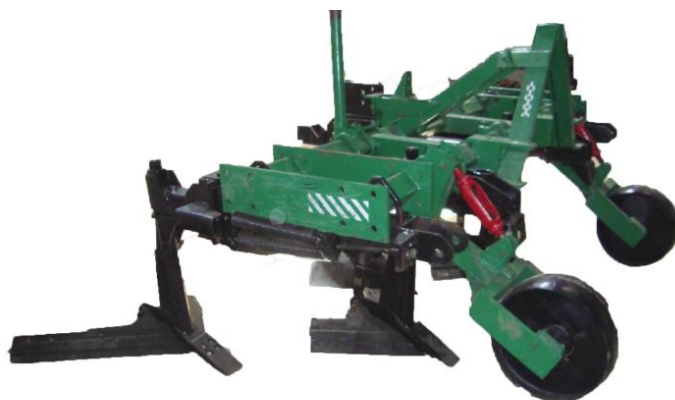
Рис. Универсальная виноградниковая машина UUM-3 в варианте сборки для культивации междурядий и межкустовых полос в виноградниках с шириной междурядий 3,0 м.
