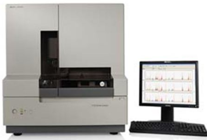
Рис. 72. Генетический анализатор АВ 3130 (Applied Biosystems). Прибор используют для секвенирования и генотипирования по молекулярным маркерам
