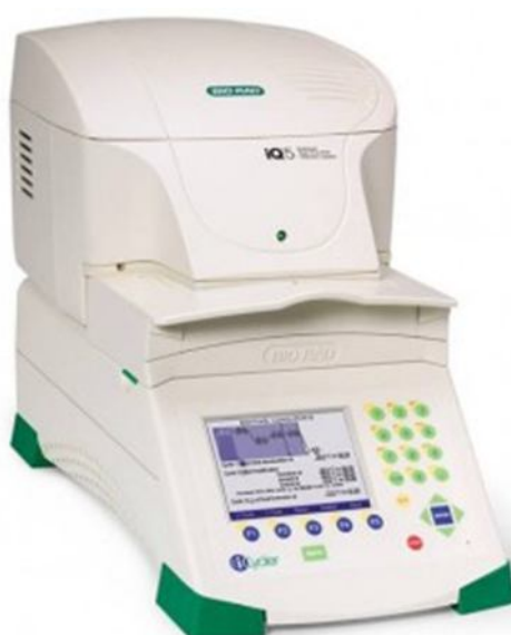
Рис. 68. Амплификатор iQ (Biogad). Прибор может быть использован как для ПЦР в реальном времени, так и для обычной (конвенционной) ПЦР
