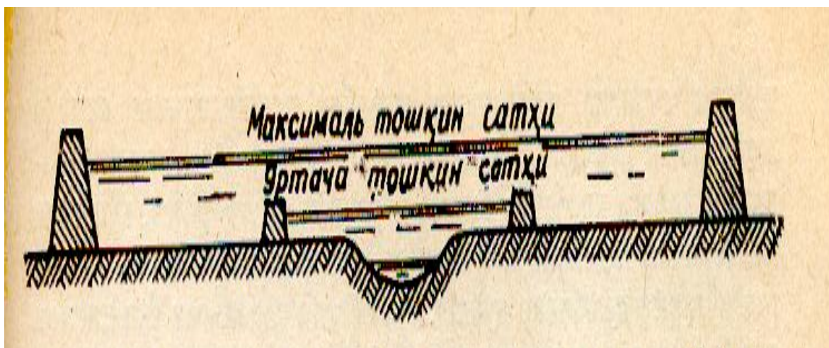
83-расм. Ўртача ва максимал сув ташқинлари ҳисобига олган ҳолда дарё ёқасига марза кўтариш (А.Н.Костяков).
