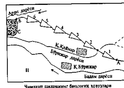
73-расм. Биологик ҳовузлар очик мезоэкосистема: А — оқава сув келадиган коллектор; 1—6—ҳовузлар; Б — оқава сув кетадиган канал; С — экин экиладиган майдон
