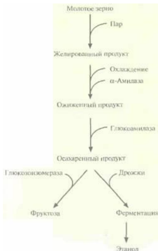
Рис. 13.10. Промышленное производство фруктозы и этанола из крахмала.
