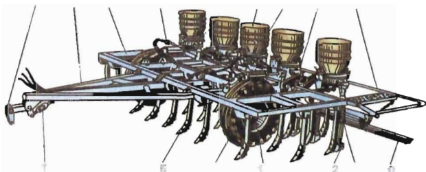
7.3.8-расми. ЧКУ-4 маркали чизель-культиватор-ўғитлагич:
