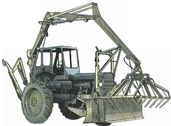
7.10.5-расми Пахтачилик хўжаликлариди ишлатиладиган ПГХ-0,5 маркали грейферли юклагич
