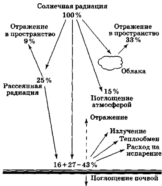
Рис. 3.2. Баланс солнечной радиации на поверхности Земли в дневное время
