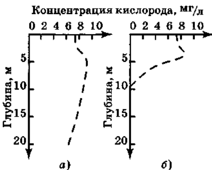
Рис. 6.13. Вертикальное изменение концентрации кислорода при одинаковой температуре в озерах (по Р. Смуту): а — олиготрофных; б — эвтрофных
