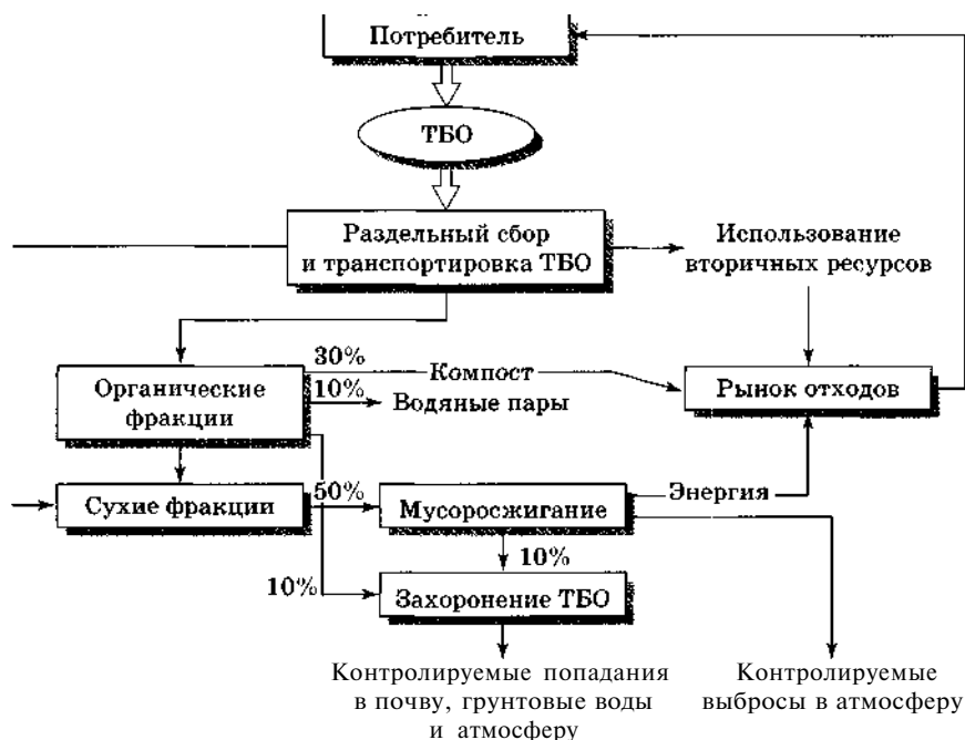
Рис. 9.12. Схема наиболее совершенной последовательности удаления отходов потребления и быта (по А. Б. Лифшицу)
