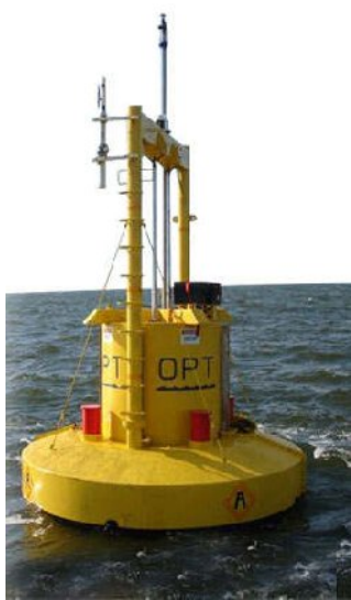
71-rasm. Po‘kakli energoqurilmalar.
