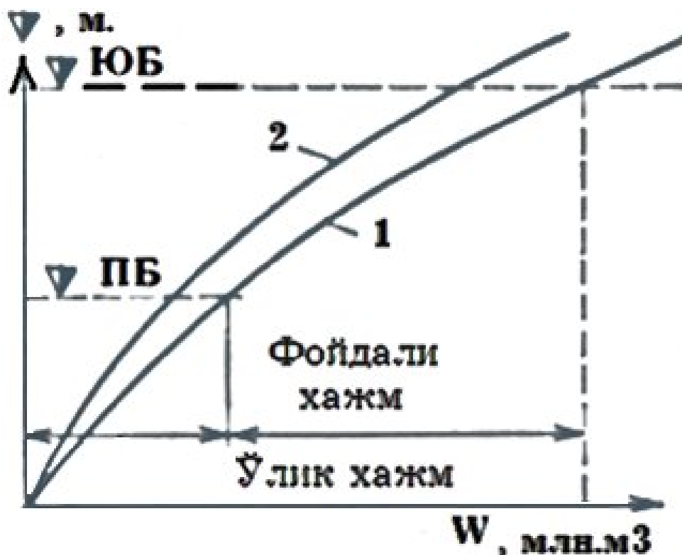
33-rasm. Suv sathi bilan hajm va suv yuzasi maydoni orasidagi bog'lanish grafiklari:
