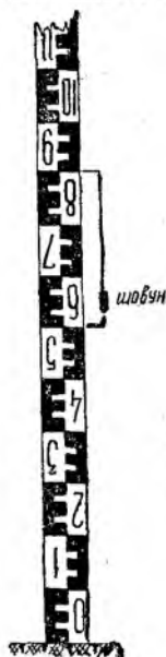
90-шакл. Шовун ёрдамида рейкани вертикал ҳолатга келтириш.
