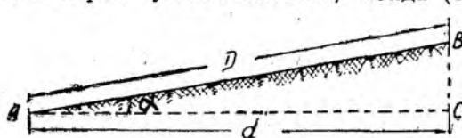
115-шакл. Жойдаги қия чизиқнинг горизонтал проекцияси.
