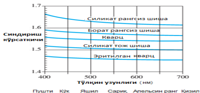
9-12 расм. Синдриш кўрсаткичи тўлқин узунлиги функцияси бўйича
