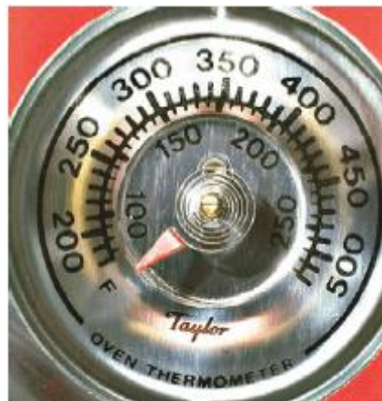
Биметалл 9-4 расм. Биметалл полоса ишлатиладиган ғалтакли термометр.
