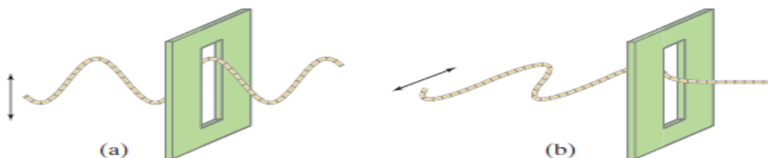
10.2. Расм (а) вертикал қутубланган тўлқин вертикал тирқишдан ўтмоқда, лекин (б) горизонтал қутублангани ўта олмайди.
