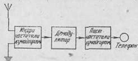
438- расм. Тўғри кучайтиргичли радиоприёмникнинг блок-схемаси.
