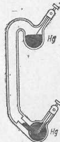
301-расм. Символи ёй лампанинг тузилиш схемаси.
