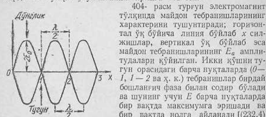
404-расм. Турғун тўлқинда электр майдон тебранишлари.
