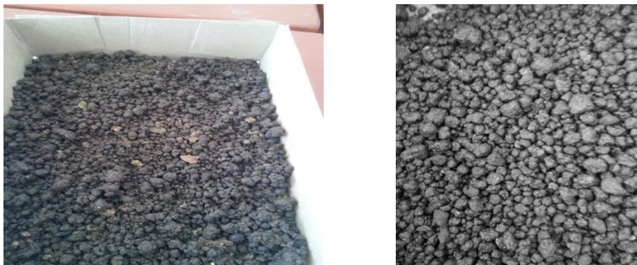
Рис. 1 – Продукт, образованный в результате химической реакции нефтешлама с негашеной известью в пропорции 1:1.
