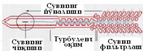
48-расм. Интеграл томизгичнинг ишлаш схемаси
