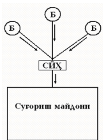
84-расм. Булоқ манбаларидан суғоришда фойдаланиш схемаси
