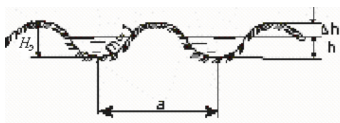
13-расм. Эгатлаб суғориш техникасини ҳисоби учун схема
