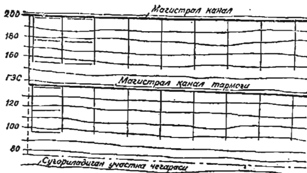
36-расм. Ёпик сугориш тармоғи режаси (магистрал канал энг кичик нишаби билан ўтказилган). Аҳмедов (1977).
