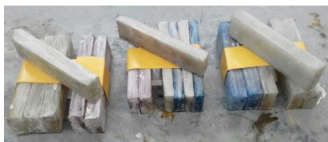
Рисунок 2. Общий вид готовых образцов после шлифования до размеров 120×30×10мм
